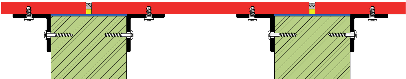
BALKONBODENPLATTE AUF HOLZTRAM VERDECKT BEFESTIGT (GESCHRAUBT)
